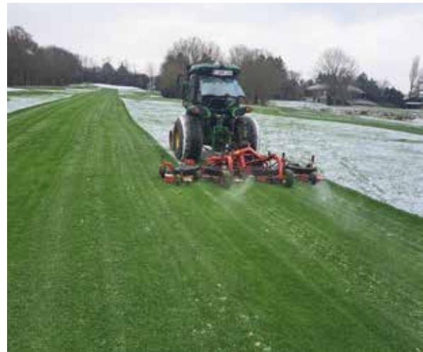
“Creatief in beheer”. De fairways waren in weken niet meer gemaaid door de onstabiele drassige ondergrond. Fairwaymaaiers kregen de klus niet meer geklaard. Het was wachten op de eerste nachtvorst begin januari om de roughmaaier in te zetten op de laagste maaistand.
